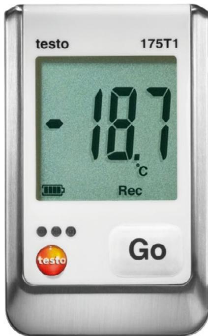
O 175-T1 é o data logger compacto para a monitorização a longo prazo de câmaras refrigeradas e frigoríficos, assim como para a documentação da temperatura de transporte em veículos de entrega. Dispõe de um canal com sensor interno, inclui suporte de parede e certificado de calibração.
